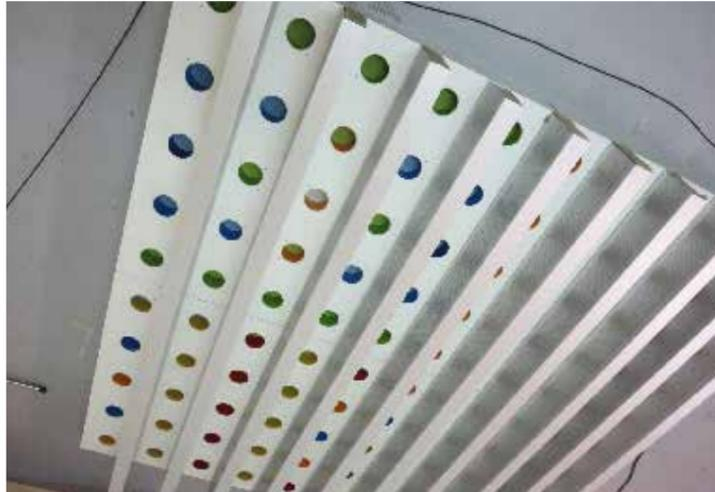
Test des baffles acoustiques en salle réverbérante.
